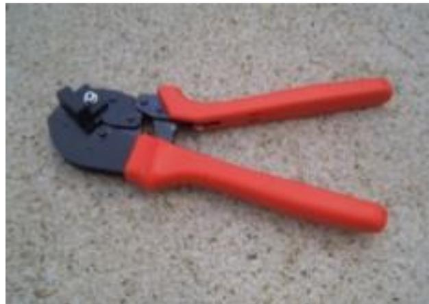
Bild 2 + 3 Krimpzange für 3 Kontaktgrößen 15 A, 30 A, 45 A
