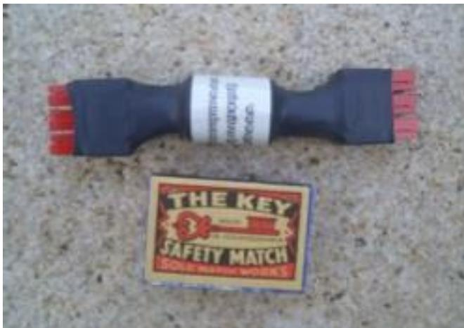
Bild 15 kompakter Verteiler mit 1 Eingang und 5 Ausgängen
