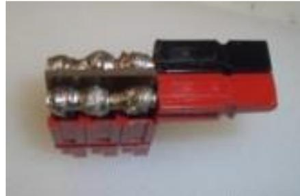
Bild 21 DJ9OZ-Block vor dem Isolieren mit Heißkleber
