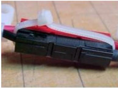
Bild 7 Kabelbinder-Fixierung
