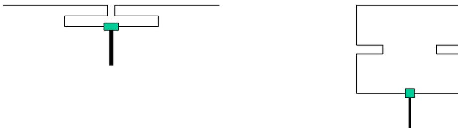
Eine weitere Art wie man Antennen relativ verlustfrei elektrisch verkürzen kann ist die Umwegleitung. Antennen mit Umwegleitungen haben, verglichen mit gleich langen Antennen die mit Spule verkürzt wurden, immer eine grössere nutzbare Bandbreite. Überdies ist eine Umwegleitung immer mit weniger Verlusten behaftet als eine Spule.
