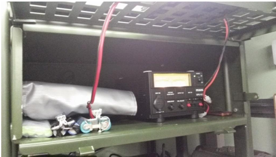
Regal rechts neben dem Operatorplatz (Oberes Fach): Ladestation mit Netzgerät
