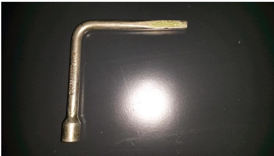
Originaler Schlüssel zum Öffnen/ Verschließen der Schaltkästen
