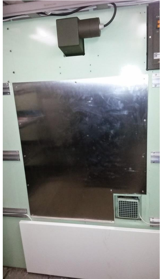
Aluminium-Blechabdeckung der Öffnungen der ehemaligen Standheizung - darunter Infrarotheizung
