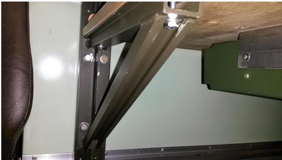
Tisch, Unterseite - Montagewinkel an C-Schiene
