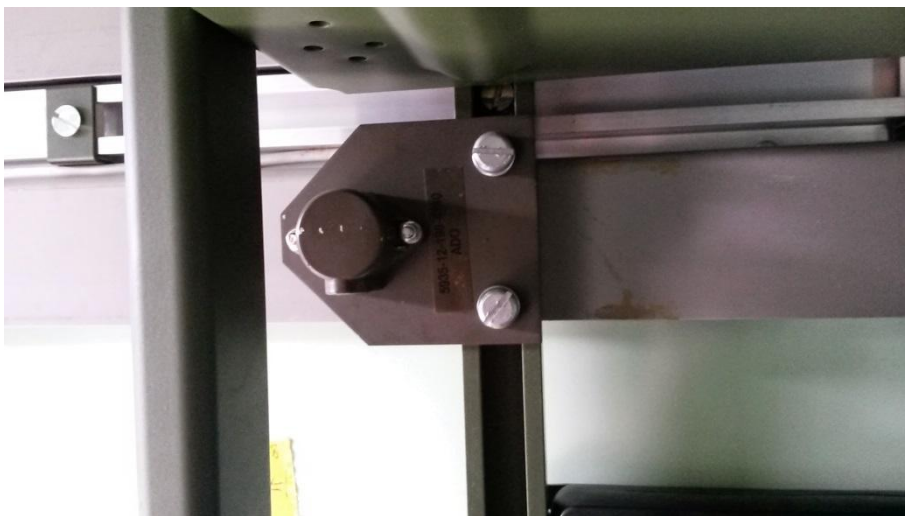
Neuer Montageort der 24 Volt Steckdose - rechts neben dem Operator
