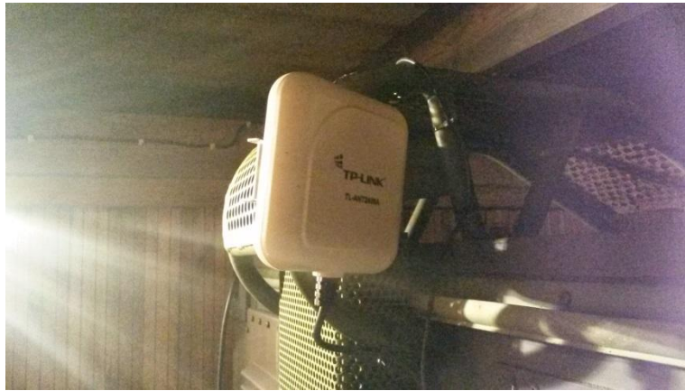
W-LAN Antenne (Hersteller TP-Link – sehr gutes Preis-/ Leistungsverhältnis)
