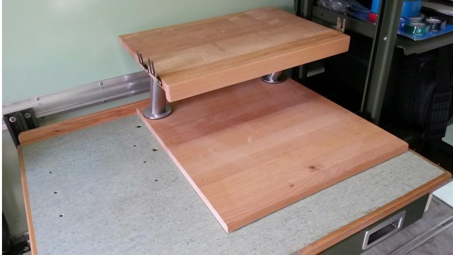
Funkgeräterack - fertig auf Tisch verschraubt
