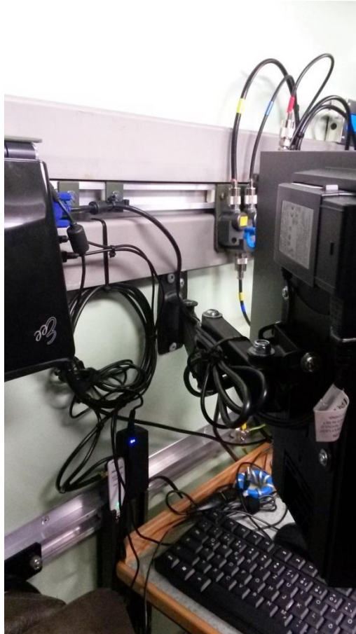
Monitor am Schwenkarm (Befestigung über VESA-Montage)
