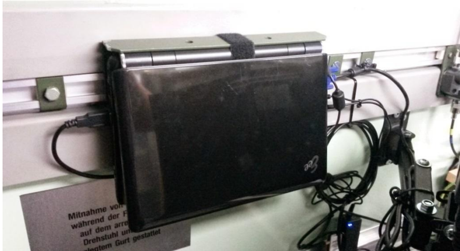
Netbook mittels Velcro-Streifen an Winkelplatte montiert (mit wenigen Handgriffen abnehmbar)
