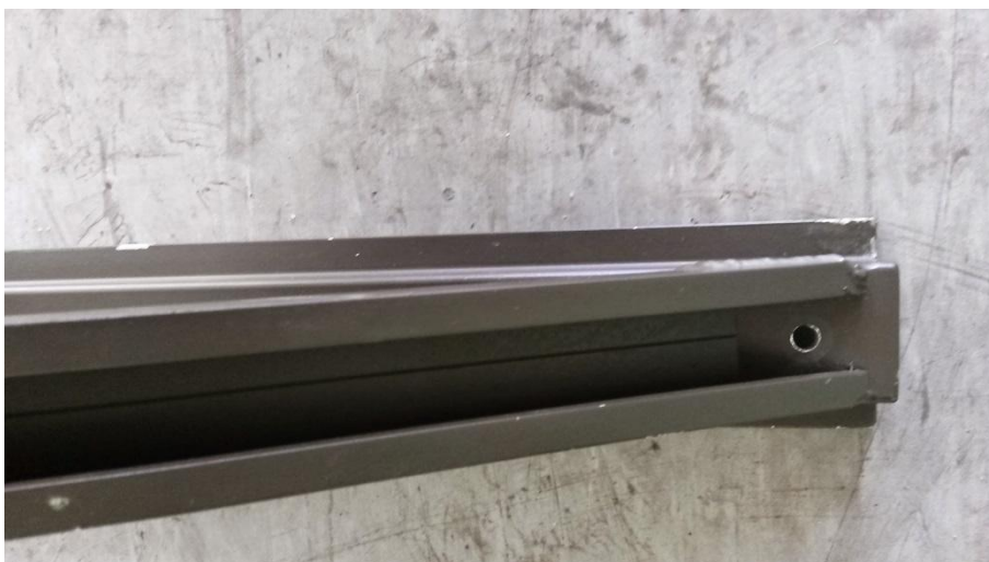
Montagewinkel mit nachträglich angebrachter Bohrung
