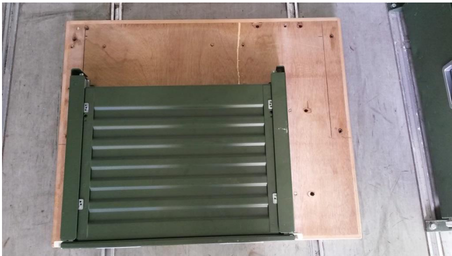
Tisch, Unterseite - Schublade und Bohrungen zur Aufnahme der Montagewinkel
