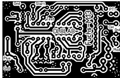
Layout der Platine Fuchssendersteuerung. Original Maße: 60 x 40 mm
